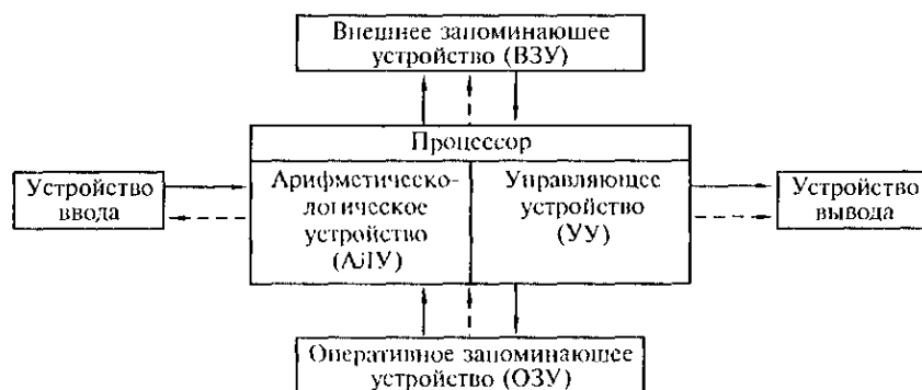
Рис. 2.1. Архитектура ЭВМ, реализующая принципы фон Неймана: ————— направление потоков информации; - - - - - направление управляющих сигналов от процессора к узлам ЭВМ
