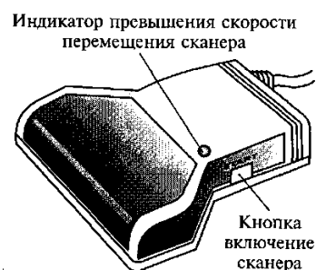
Рис. 6.9. Устройство ручного сканера
