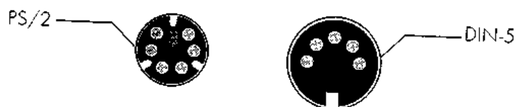
Рисунок 2 Разъемы для клавиатуры и мыши типа DIN-5 и PS/2
